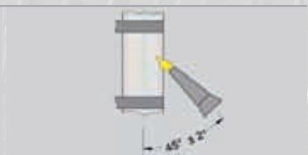
Résistance à la propagation de flammes selon la norme Flexa 1008 Resistance against flame spreading acc. to Flexa norm 1008
