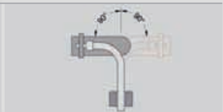
Essai de flexibilité/essai de flexions alternées selon la norme Flexa 1036 Flexibility test / Alternate bending test acc. to Flexa norm 1036
