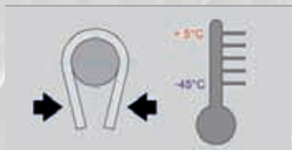
Température minimale d'utilisation prolongée et d'installation selon la norme Flexa 1008 Minimum continued use and installation temperature acc. to Flexa norm 1008
