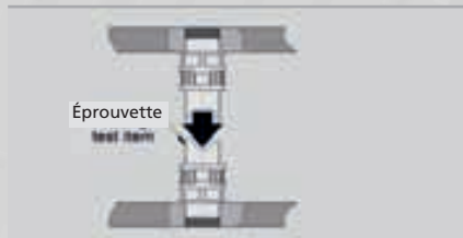
Essai de résistance à la traction / d'extraction selon la norme 1008 Tensile strength test / Pull out test acc. to Flexa norm 1008
